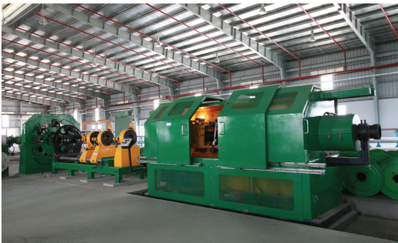
Hệ thống drum twister Drum twister system
